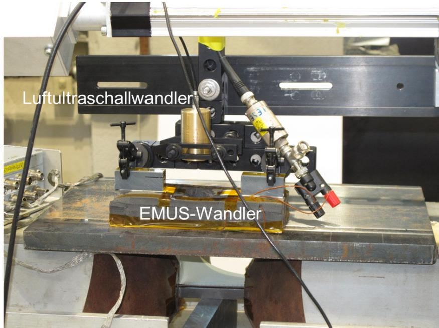
**Abb. 6** Versuchsaufbau zur einseitigen Prüfung im Impuls-Echo-Verfahren an einer 20 mm dicken Stahlplatte
