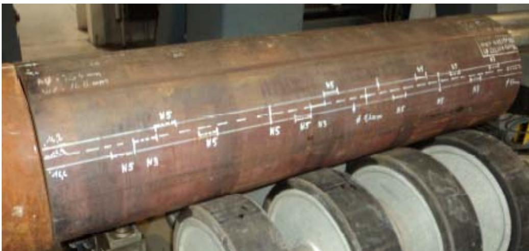
**Bild 4** Erstellung des Testkörpers gemäß DNV-OS-F101
