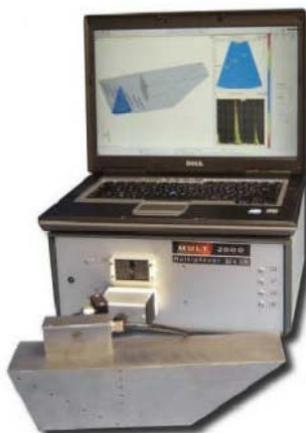
**Bild 7** Multi2000 Phased Array Gerät
