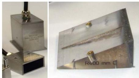
**Bild 6** Bsp. eines Phased Array Prüfkopfes, inkl. Vorlaufschuh der Firma Imasonic
