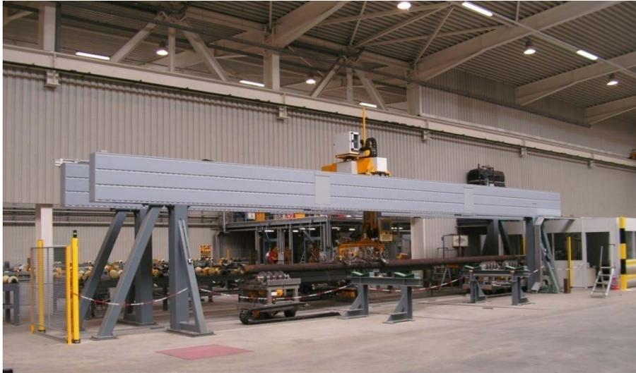
**Bild 8** AS 200 Rohrprüfsystem basierend auf der Phased Array Technologie
