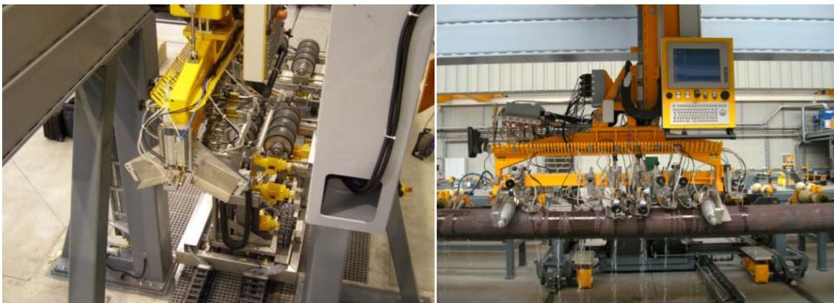
**Bild 9** Beispiel einer Prüfspinne mit Phased Array Ultraschallprüfköpfen
