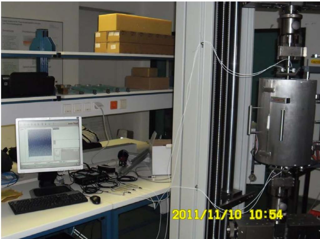
Abbildung 2: Hochtemperatur-Messplatz mit Hochtemperaturofen und Zugmaschine
