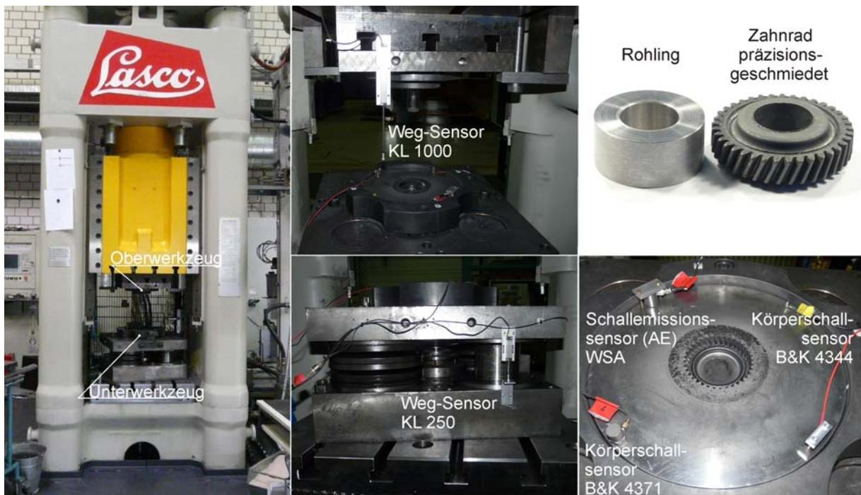
Abbildung 1: Versuchsaufbau
