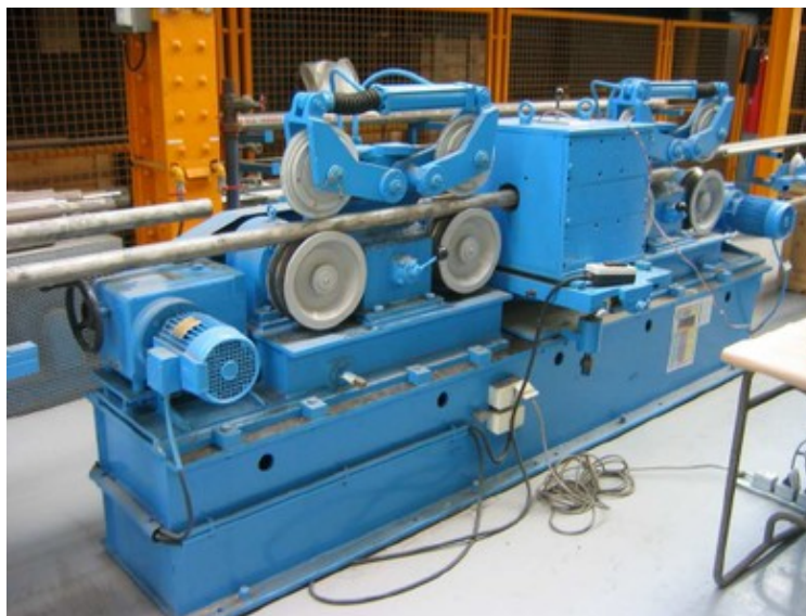
Abbildung 3: Wirbelstromprüfanlage im Vallourec-Forschungszentrum
