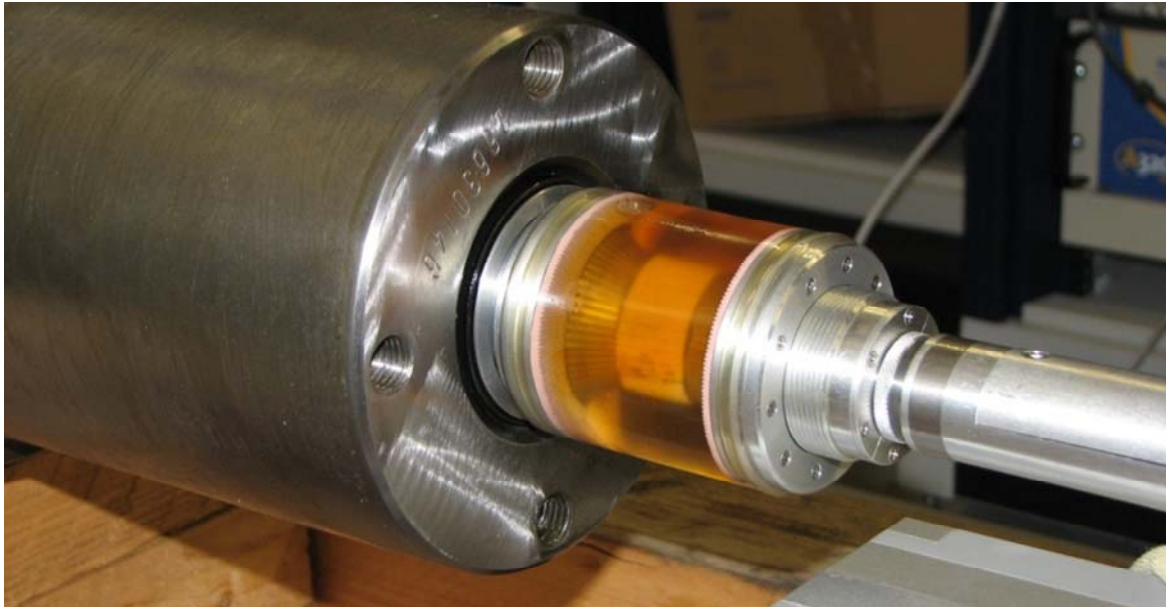
Bild 8. Kegelarray-Prüfkopf im Prüfsystem
