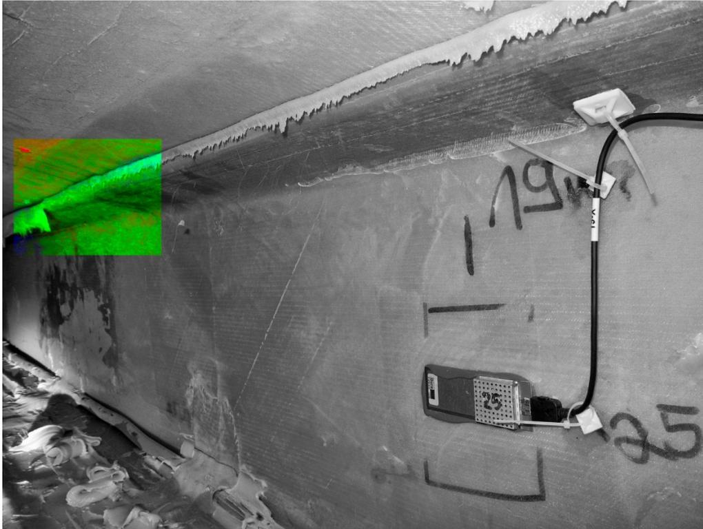
Abbildung 5: farblich hervorgehobene Undulationen im Glasfaser-Komposit des Nasenkantengurts bei R=20,5 auf der Druckseite
