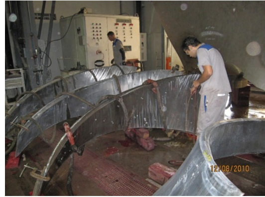
Francisschaufel bei der Magnetpulverprüfung
