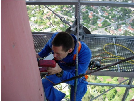
Oberflächenprüfung am Wiener Donauturm
