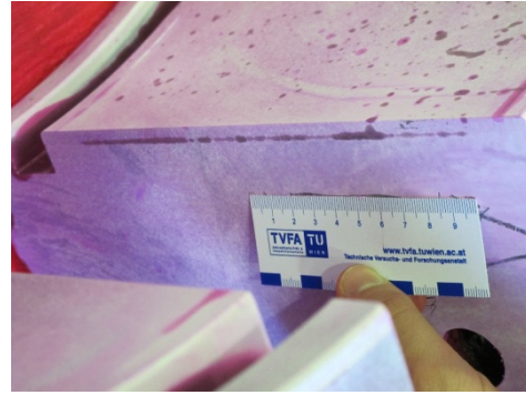
Fehleranzeigen im Lagermetall
