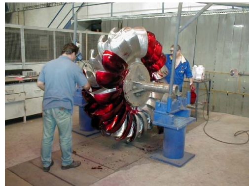
Peltonlaufrad bei der Eindringprüfung
