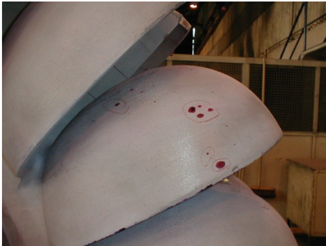
Porenanzeigen in einem Peltonlaufrad
