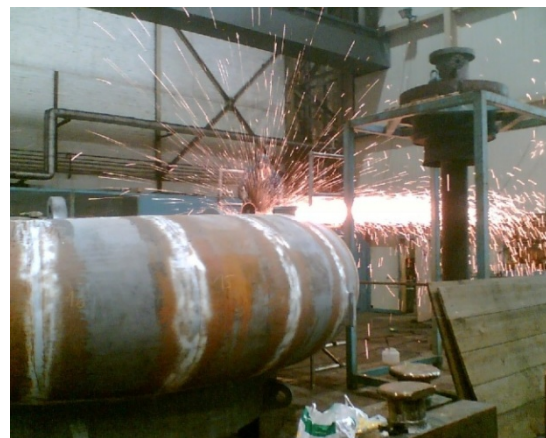
Spirale während der Fertigung
