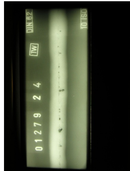
Fehleranzeigen in einer Schweißnaht
