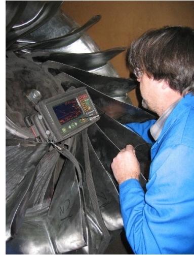
UT Francislauftrad während der Fertigung
