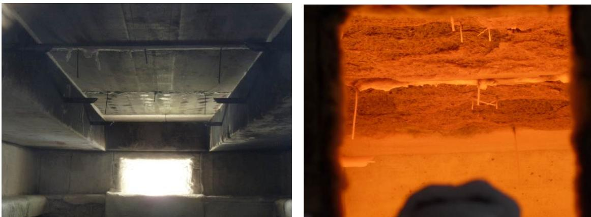
**Abb. 3:** Blick ins Ofeninnere, links vor Versuchsbeginn mit intakten Probekörpern, rechts während des Versuchs mit bereits geschädigten Probekörpern.
