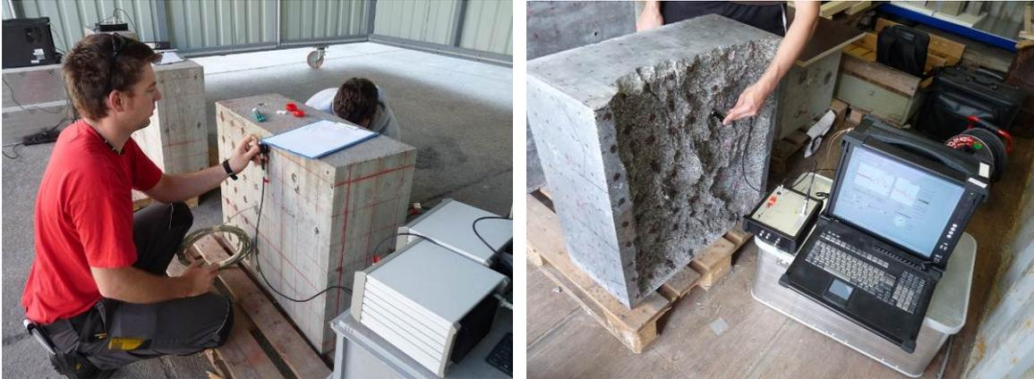
**Abb. 4:** Ultraschalluntersuchungen in Durchschallung an den Betonprobekörpern vor (links) und nach (rechts) der Brandeinwirkung.
