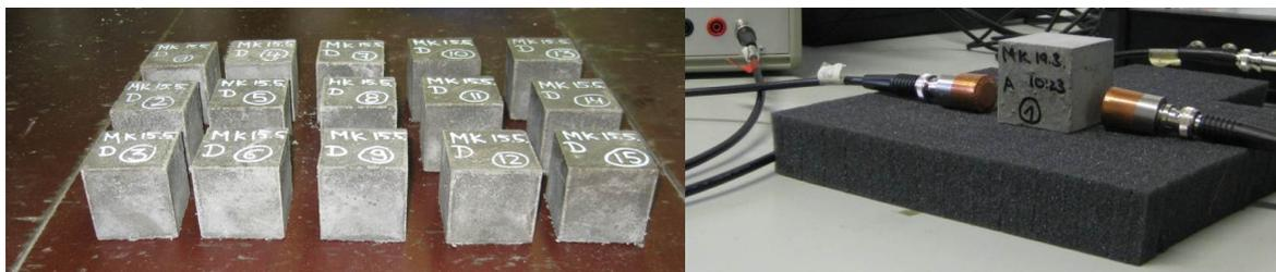
**Abb. 9:** Würfel mit einer Kantenlänge von 4 cm (Links) die für die Untersuchungen im Ofen erwärmt und anschließend die Schallgeschwindigkeit in Durchschallung bestimmt wurde (Rechts).
