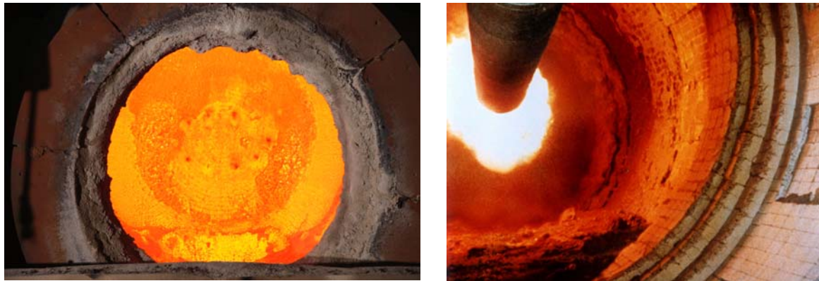
Bild 1. Feuerfeste Erzeugnisse als Wandmaterialien in einem Konverter zur Stahlerzeugung (links) und in einem Zement-Drehrohrofen bei der Zementerzeugung (rechts) [Fotos: RHI]
