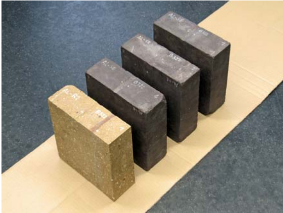
Bild 5. Keilförmige Steine (links): Liniemessung mit luftgekoppeltem Ultraschall in Durchschallung (rechts)
