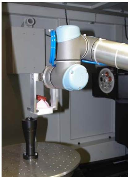
Abbildung 2: Links: Der automatisch angesteuerte Roboter beim Bestückungsvorgang. Rechts: Werkstückträgersystem mit aufgespannten Bauteilen.
