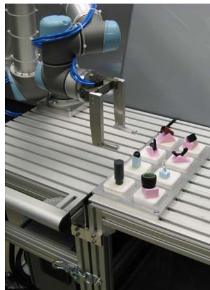
Abbildung 2: Links: Der automatisch angesteuerte Roboter beim Bestückungsvorgang. Rechts: Werkstückträgersystem mit aufgespannten Bauteilen.
