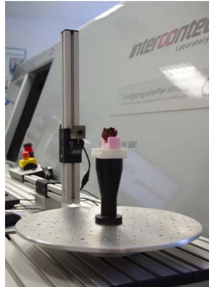
Abbildung 1: Links: Automatisches Filterwechselsystem zur Variation des Röntgenspektrums. Rechts: Externer Rüstplatz zum Aufspannen und Zentrieren.
