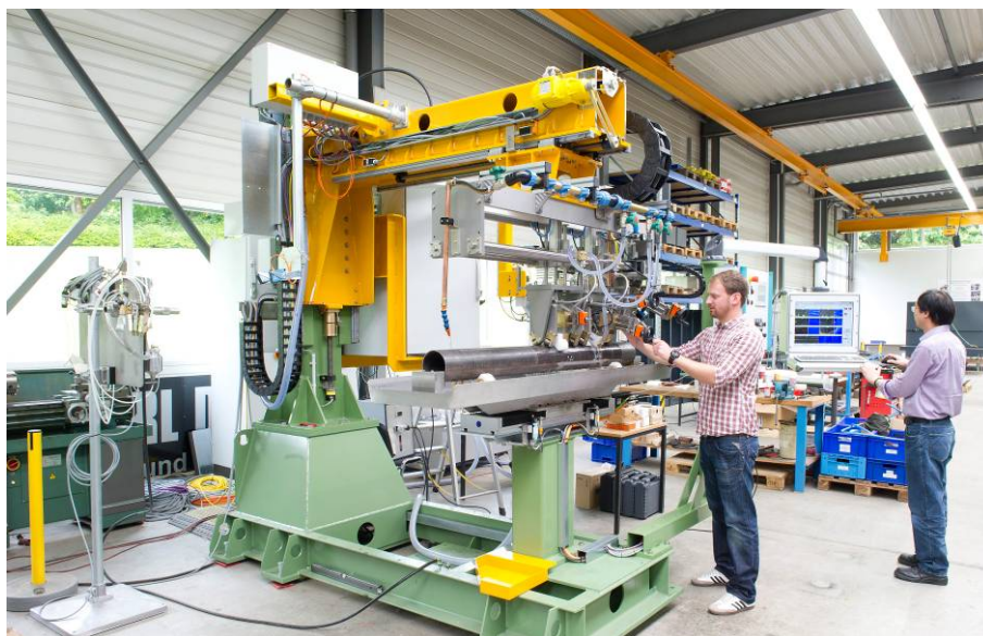
Abb. 9: Phased Array - Prüfsystem vor dem Versand im Anlagenbau von KARL DEUTSCH
