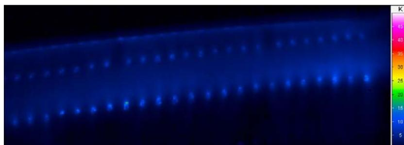
Abbildung 8 Thermogramm nach 2s Erwärmung mit heißer Luft ( $T=180^{\circ}\text{C}$ ,  $\Delta p=0,5\text{bar}$ )
