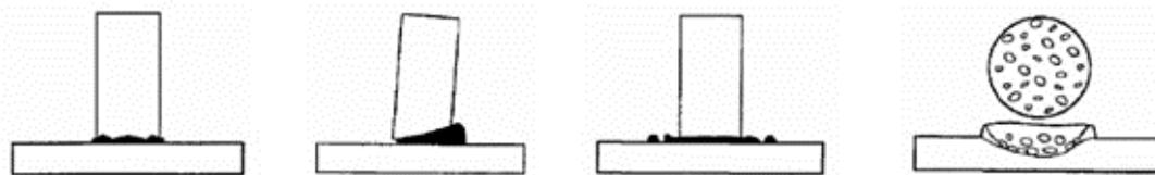
**Abbildung 1:** v.l.n.r.: schwach ausgebildeter, ungleichmäßiger Schweißwulst mit matter Oberfläche; Schweißwulst einseitig mit Unterscheidung; Schweißwulst niedrig, Oberfläche glänzend mit starken Spritzern, Bruch in der Schweißung).
