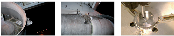
Links und Mitte: Versagen einer Turbinenscheibe (Boing 767, 2006) (www.dauntless-soft.com)
