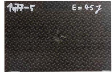
Monolithische CFK-Probe mit Impakt-Schaden
