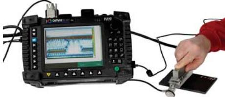
Ultraschall-Prüfung mit Gruppenstrahler-Prüfkopf 5MHz
