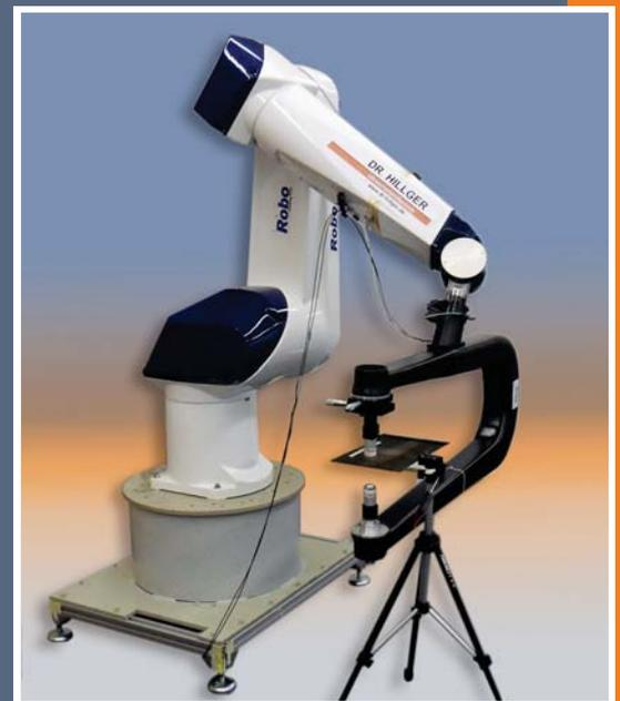
Demonstrator: USPS 4000AirTech kombiniert mit einem Roboter, XY-Scan
