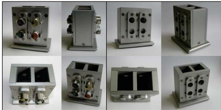
Abbildung 2: Laboraufbau mit bzw. ohne Ultraschallwandler, Einstellung des Schalllaufweges über Abstandshalter
