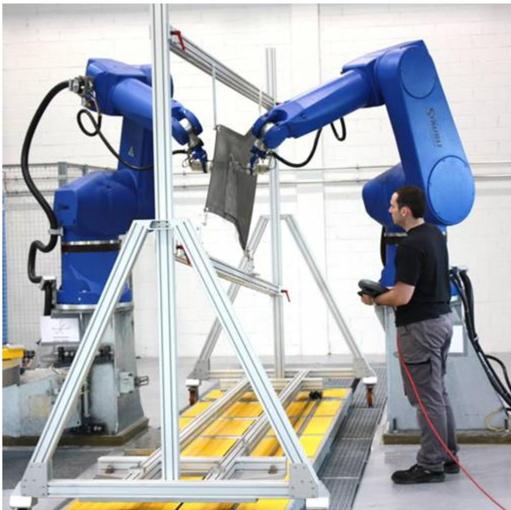
**Bild 1:** Moderne, voll 3D-fähige Doppelroboter- Ultraschallprüfanlage für Durchschallung von komplex geformten CFK-Bauteilen
