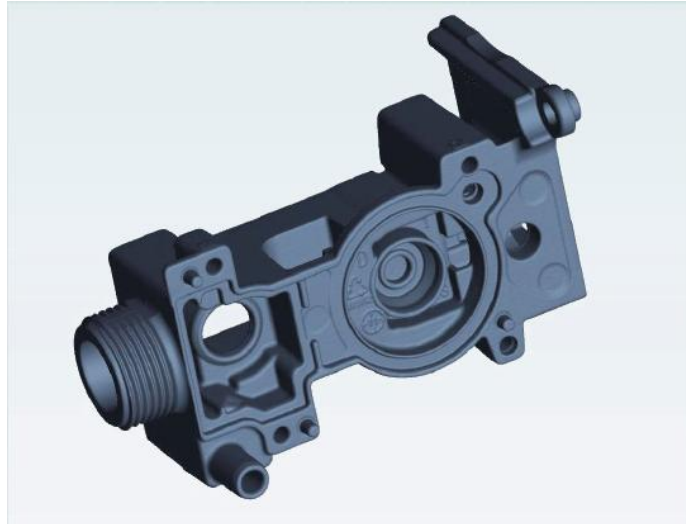
Abbildung 3: Die Flächendaten beinhalten alle inneren und äußeren Strukturen
