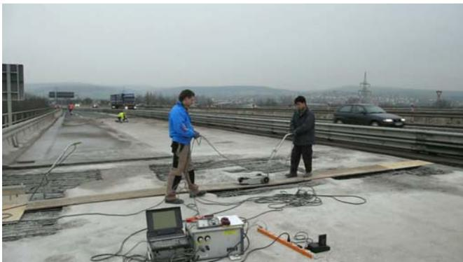
**Abbildung 2: Messung des Streufelds einer Brückenplatte mit herkömmlicher Messtechnik [TU Berlin, Fachgebiet Baustoffe und Baustoffprüfung]**
