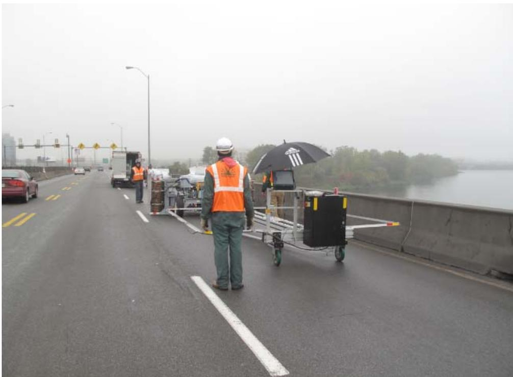
**Abbildung 14: Der Großmagnet mit Rotationssensor bei dem Einsatz auf der Champlain Bridge in Montreal**
