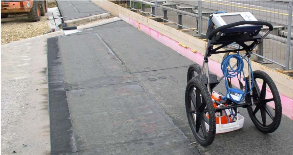
Abbildung 7: Radarmessung (900MHz) um obere und untere Querspannglieder zu bestimmen
