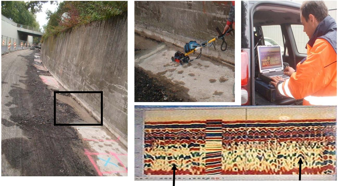
**Abbildung 9:** links: Wasser auf Messfläche, mitte oben: Radarmessung; mitte unten: Ergebnis von Radarmessungen mit Bewehrung und Lage von Spanngliedern; rechts: Messung und Auswertung in situ
