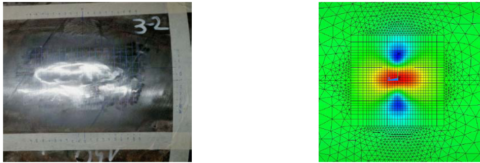
Bild 2: Korrosionsstelle (links) und numerische Berechnung der Spannungssituation (rechts)
