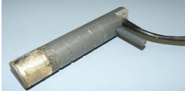
Abbildung 5: Wirbelstrom-Radiensensor
