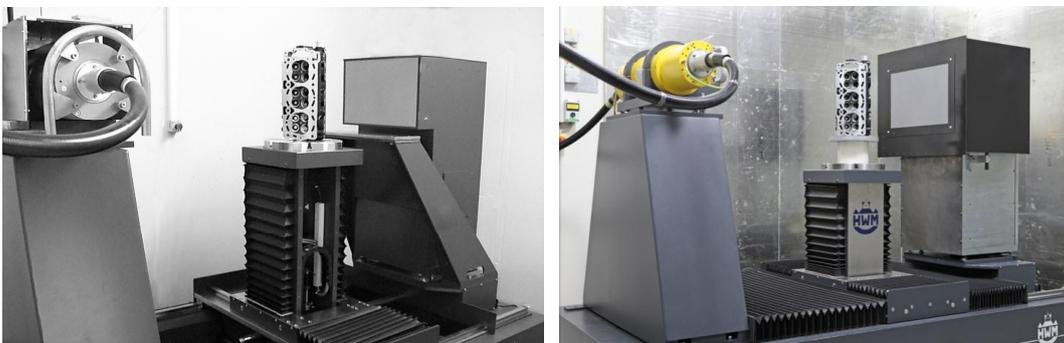
Figur 1: Vergleich der unterschiedlichen Aufbauten vor (links) und nach der Optimierung (rechts). Wichtigste Veränderungen sind das neu entwickelte Detektorgehäuse aus Faserverbundplatten, einem nicht abgebildetem Folien-spiegel und der Metallverkleidung der Wände.
